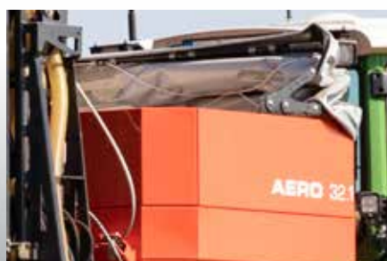
Optioneel op afstand bedienbaar afdekzeil met AP-Drive
