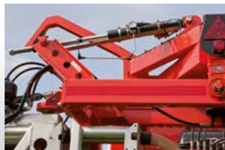
Distance control: Automatisch actieve boomgeleiding
