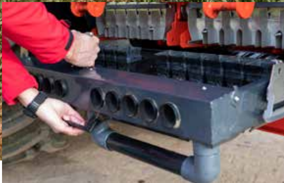
Eenvoudig wegzwenken van de injectorcassette
